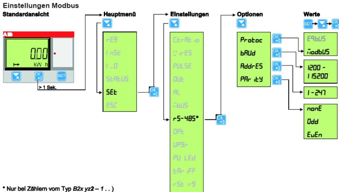
Baudraten muss als Default-Wert „**38400**“ eingestellt werden, um eine Kommunikation mit dem Interfacemodul gewährleisten zu können.
