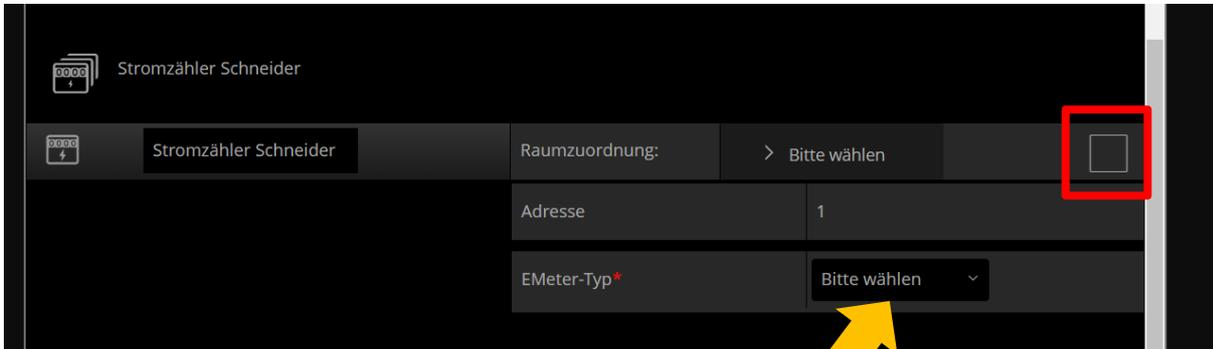
Als EMeter-Typ muss hier „Batterie“ ausgewählt werden. Die Adresse muss nach Klemmpunkt am Interfacemodul bezeichnet werden z.B. mit „1“, als Protokoll muss „Modbus RTU“ verwendet werden. Der Port ist wie folgt zu beschriften „/dev/ttyMXC“. Zum Verwenden muss oben noch der Hacken gesetzt werden, um die Einstellungen zu bestätigen.
